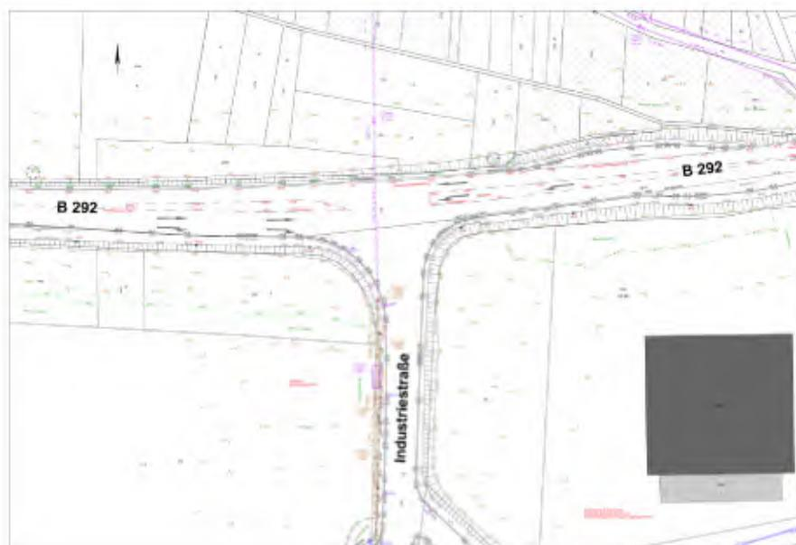
In den Geltungsbereich des Bebauungsplanes einbezogen werden sämtliche Grundstücke, bzw. Teilflächen, die für die geplante Errichtung eines Verkehrskreisels, einschließlich sämtlicher Anschlüsse benötigt werden. Vorgesehen und im Bebauungsplan-Entwurf planungsrechtlich dargestellt ist die Errichtung eines „Kreisverkehrs“ mit drei Ästen. Der Außendurchmesser wurde aufgrund der verkehrlichen Anforderungen mit 45,00 m gewählt. Der Kreiselmittelpunkt liegt in der bestehenden Achse der B 292.
