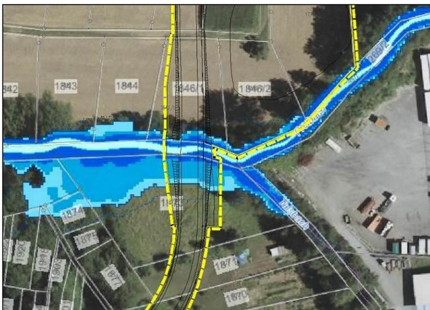
Abbildung 10: Überflutungsflächen HQ100 gem. HWGK im Eingriffsbereich (gelb) und seiner Umgebung
